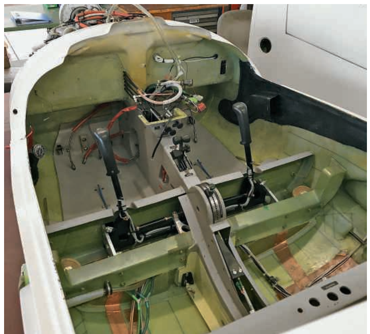
Flugsteuerung und Instrumente wurden komplett ausgebaut.
