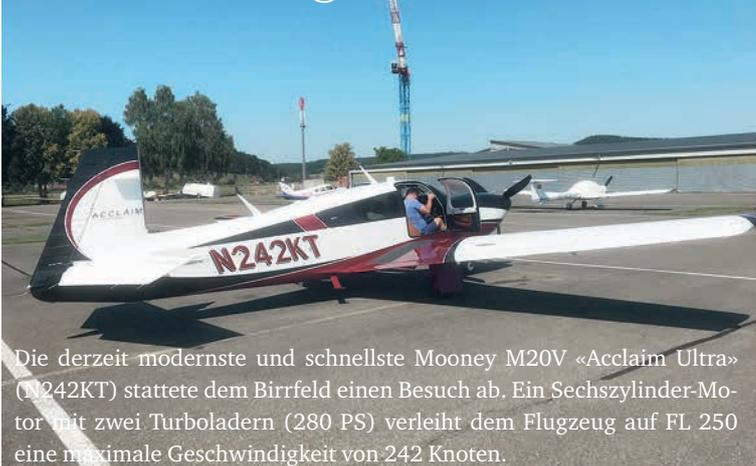
Die derzeit modernste und schnellste Mooney M20V «Acclaim Ultra» (N242KT) stattete dem Birrfeld einen Besuch ab. Ein Sechszylinder-Motor mit zwei Turboladern (280 PS) verleiht dem Flugzeug auf FL 250 eine maximale Geschwindigkeit von 242 Knoten.
